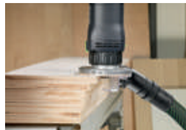
Fazetovacie frézovanie lepených častí z plastu alebo masívneho dreva.
