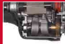
Vyrovnávací mechanizmus zabezpečuje nízke vibrácie - 12,5 m/s 2
